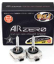
D1バルブはヨーロッパ系の車種に搭載されているバルブで、イグナイターがバルブに直接取付けられているタイプです。AIR ZERO D1S HP6000Kは通常電力の中で最高のパフォーマンスを提供し、通常の6000Kに対し120%の光量パフォーマンスと純白色を実現。
