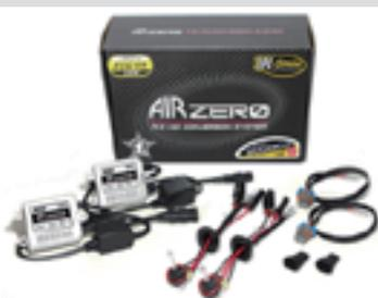
インバーターとイグナイターが分離したセパレートタイプのバラストを採用し、コンパクトなバラストは狭いエンジンルームやバンパー内への設置が容易なので、取付けスペースが狭い車両でも装着が可能です。25W FOG用システムのバルブは、バラストの出力特性を考慮した専用設計で、明るさ約20%アップ(当社比)を実現したHP6000Kを含む個性豊かな5色をラインナップしたハイクオリティーバルブを使用しています。バラストとバルブ間のカプラーには、従来品よりも幅が広い端子を使用して、接続カプラーでの電力ロスや接触不良を低減させています。
